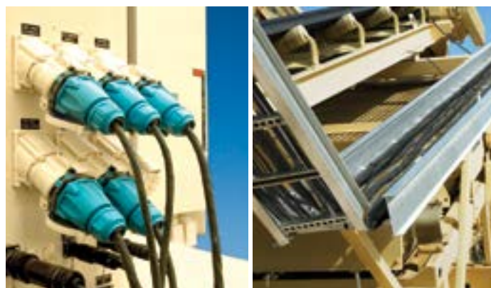
Штекеры быстро подсоединяют кабели к силовым панелям.
